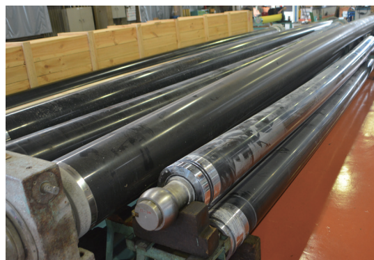
メンテナンスのため工場に一時返却されたエキスパンダー。使用環境や搬送速度などに応じて多種多様な提案が可能
