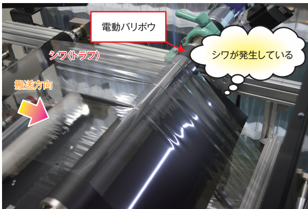
搬送ローラのミスアライメントによってシワが発生
