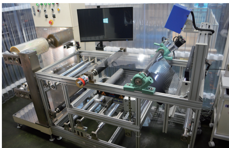
カンセンエキスパンダー工業に設置されたシワ自動除去装置のデモ機（左）。LED光源から光を当て、カメラで観察する仕組み
