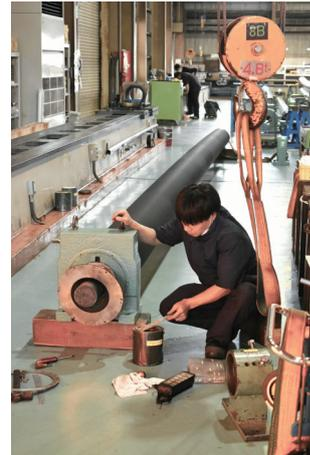
長尺ロールを製造する第1工場。製紙向けのロールは長く、10m超になるものも
