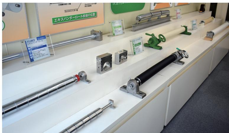
電動バリボウ、ストレートバリボウなど素材、用途に応じたラインアップがそろったエキスパンダーロール
